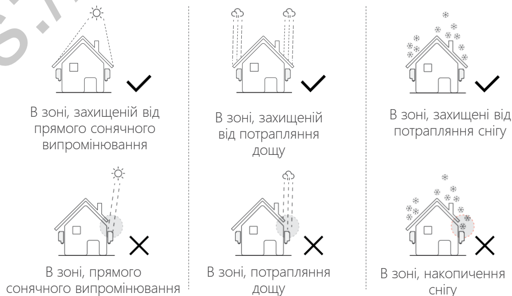
Рекомендовані місця для встановлення
