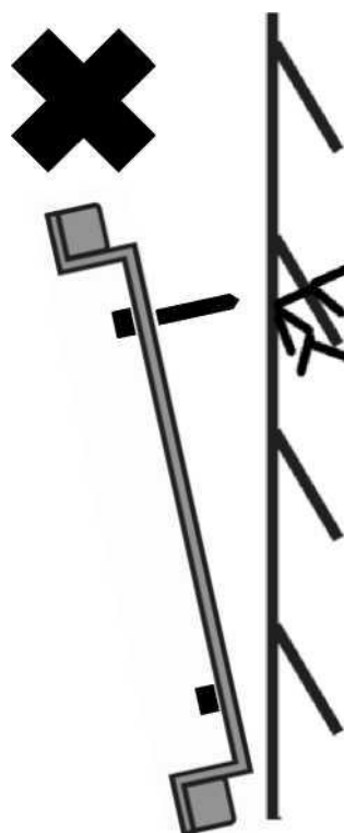
Малюнок 15 – Кріплення монтажних рамок на стіні
