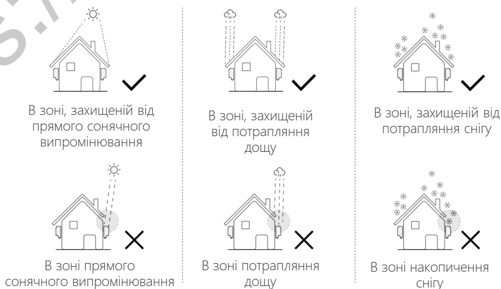
Рекомендовані місця для встановлення
