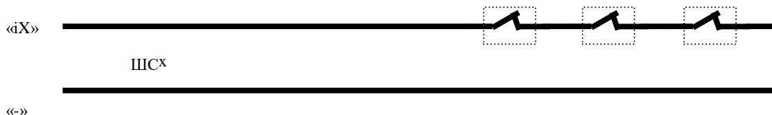
Если «Конфигуратором» в настройках проводных зон установлен тип шлейфа «классический охранный» (контролируется НАРУШЕНИЕ/ВОССТАНОВЛЕНИЕ датчика и «КОРОТКОЕ ЗАМЫКАНИЕ» шлейфа), то датчики с Н3 контактами необходимо подключать к прибору по следующей схеме:
