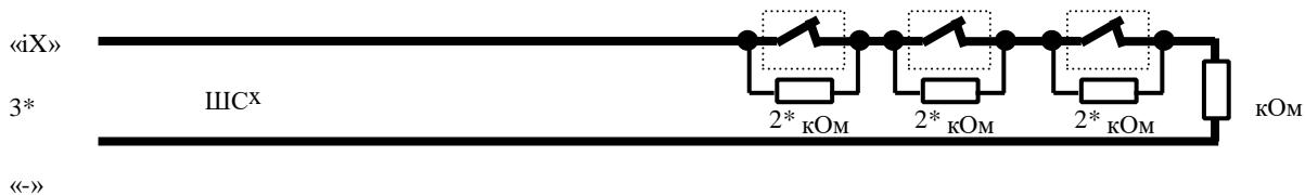
Если «Конфигуратором» в настройках проводных зон установлен тип шлейфа «двоих-зонный параметрический ОКО» (контролируется НАРУШЕНИЕ/ВОССТАНОВЛЕНИЕ датчика зон-1,-5 или зон-2,-6 или зон-3,-7 или зон-4,-8, а также «КОРОТКОЕ ЗАМЫКАНИЕ», «ОБРЫВ» шлейфа), то датчики двух зон с Н3 контактами необходимо подключать к прибору по следующей схеме:
