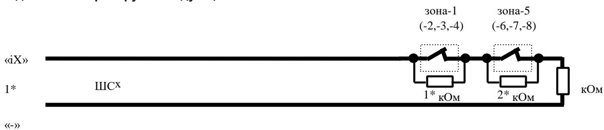
Пример подключения двух датчиков движения, используя «двоих-зонный параметрический шлейф ОКО», «круглосуточно» контролирующий также и вскрытие любого из датчиков (произойдет «ОБРЫВ» шлейфа)
