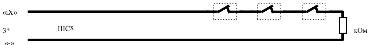
Если «Конфигуратором» в настройках проводных зон установлен тип шлейфа «параметрический охранный» (контролируется НАРУШЕНИЕ/ВОССТАНОВЛЕНИЕ датчика и «КОРОТКОЕ ЗАМЫКАНИЕ», «ОБРЫВ» шлейфа), то датчики с Н3 контактами необходимо подключать к прибору по следующей схеме:
