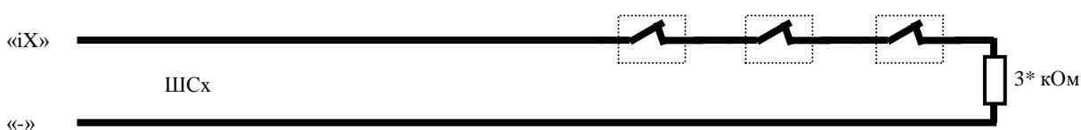
Если «Конфигуратором» в настройках проводных зон установлен тип шлейфа «параметрический охранный» (контролируется НАРУШЕНИЕ/ВОССТАНОВЛЕНИЕ датчика и «КОРОТКОЕ ЗАМЫКАНИЕ», «ОБРЫВ» шлейфа), то датчики с НЗ контактами необходимо подключать к прибору по следующей схеме:
