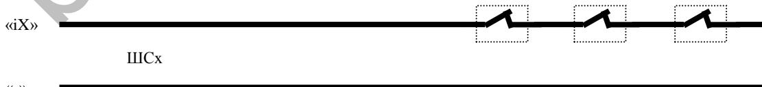
Если «Конфигуратором» в настройках проводных зон установлен тип шлейфа «классический охранный» (контролируется НАРУШЕНИЕ/ВОССТАНОВЛЕНИЕ датчика и «КОРОТКОЕ ЗАМЫКАНИЕ» шлейфа), то датчики с Н3 контактами необходимо подключать к прибору по следующей схеме:
