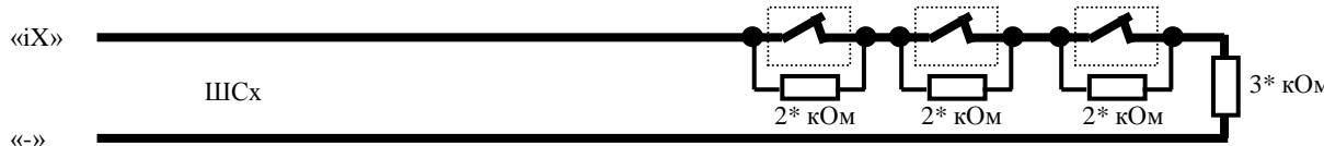
Если «Конфигуратором» в настройках проводных зон установлен тип шлейфа «двуухзонный параметрический ОКО» (контролируется НАРУШЕНИЕ/ВОССТАНОВЛЕНИЕ датчика зон-1,-5 или зон-2,-6 или зон-3,-7 или зон-4,-8, а также «КОРОТКОЕ ЗАМЫКАНИЕ», «ОБРЫВ» шлейфа), то датчики двух зон с НЗ контактами необходимо подключать к прибору по следующей схеме:
